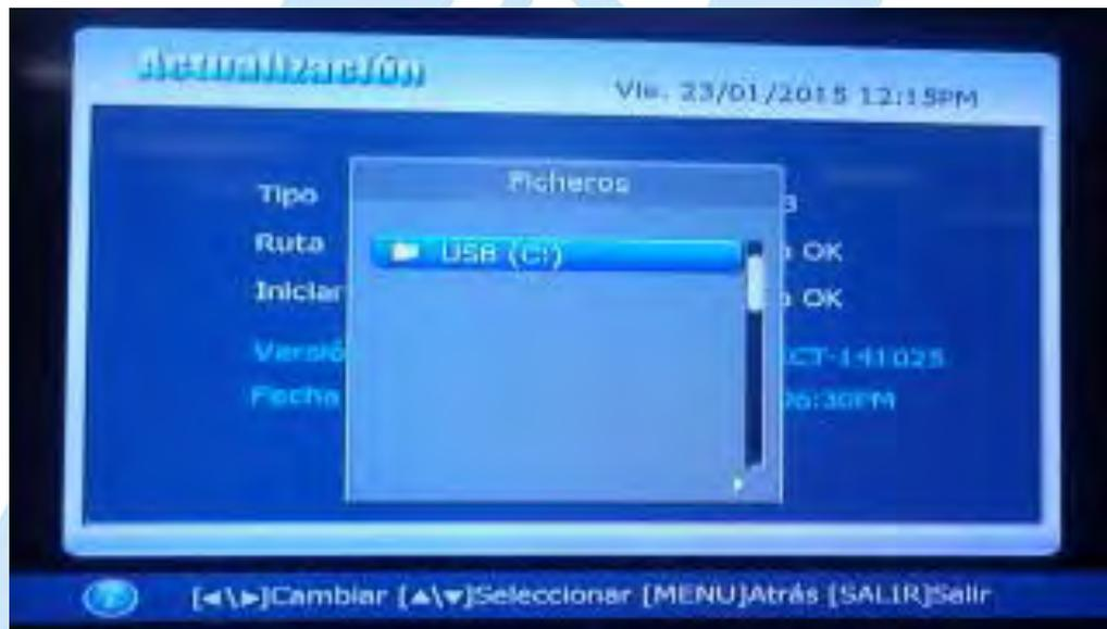
7. Presione la tecla OK del mando a distancia y empleando las teclas ▲▼, seleccione el fichero de actualización ubicado en su dispositivo USB. Presione nuevamente OK para regresar a la ventana de actualización.
