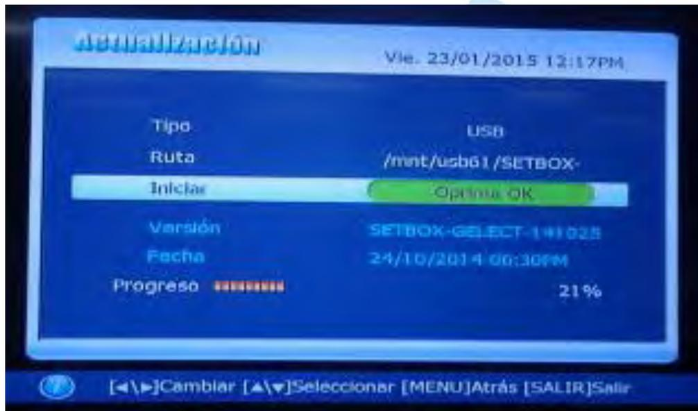
10. Una vez la barra de progreso llegue al 100%, habrá terminado el proceso de actualización, con lo cual el equipo se reiniciará automáticamente. Normalmente en este proceso el STB borra todos los canales que había guardado, por lo que usted deberá realizar una nueva búsqueda de canales accediendo a **"MENU→Búsqueda"** y seleccionando una de las opciones de búsqueda: Manual o Automática.
